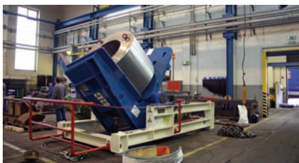
Bild: 80-t-Wendeeinheit für U-Boot Sektion
