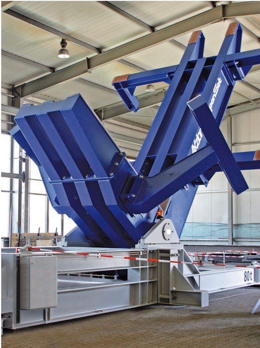
Bild: 80-t-Wendeeinheit für U-Boot Sektion
